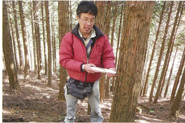
▲ピロディンによる陥入試験
