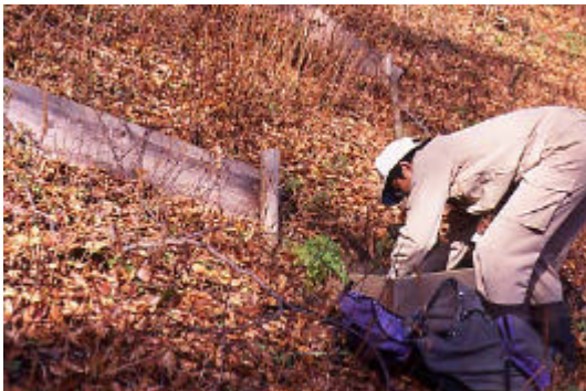
写真 -3 土壌調査枠を用いた土壌流出量の測定風景
