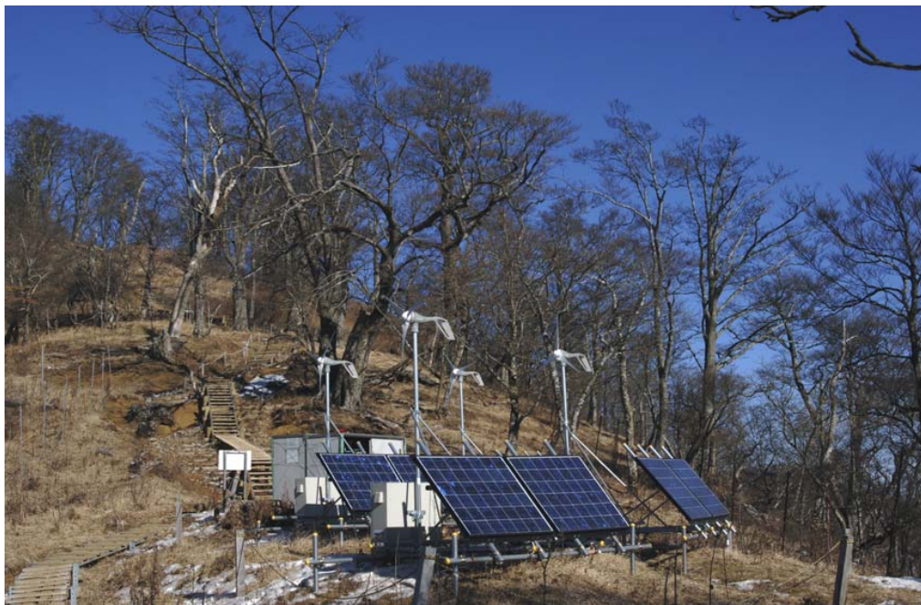
檜洞丸山頂での連続観測装置. 2004年から測定
