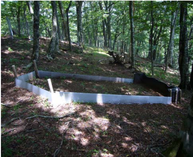
図 2-1-19 土壌侵食量測定枠工 (無施設地比較用) (2006年8月撮影)
