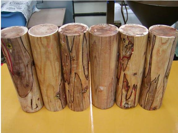
写真-1. 腐朽促進試験材料(スギ被害材)
