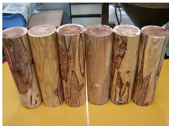
写真-1. 腐朽促進試験材料(スギ被害材)
