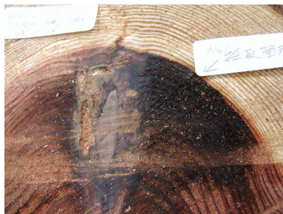
写真-4. スギ被害部と黒変状況
