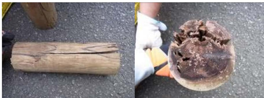
写真4. 強度試験を実施したスギ被害材の加重部側面（左）と断面（右）
