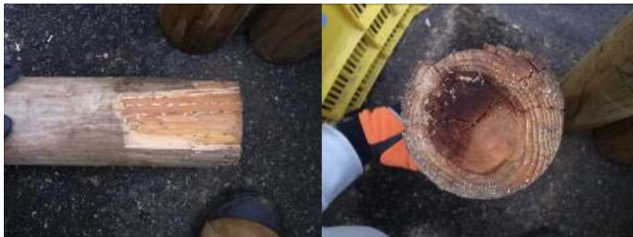
写真3. 強度試験を実施したスギ健全材の加重部側面（左）と断面（右）
