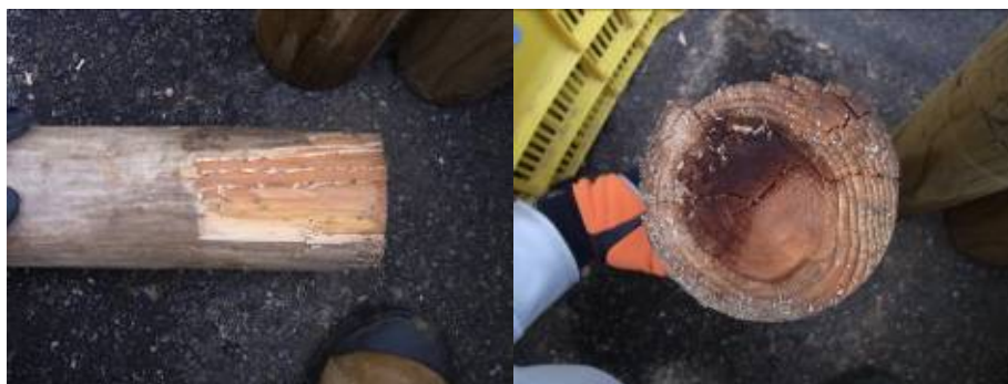
写真3 3年区のスギ健全材の加重部側面（左）と断面（右）
