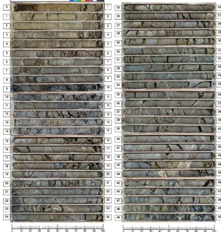
写真1 ボーリング現場(上)と採取コア(下)
