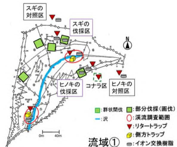
図-2 流域1の群状伐採か所と物質循環機構の測定地点（継続）
