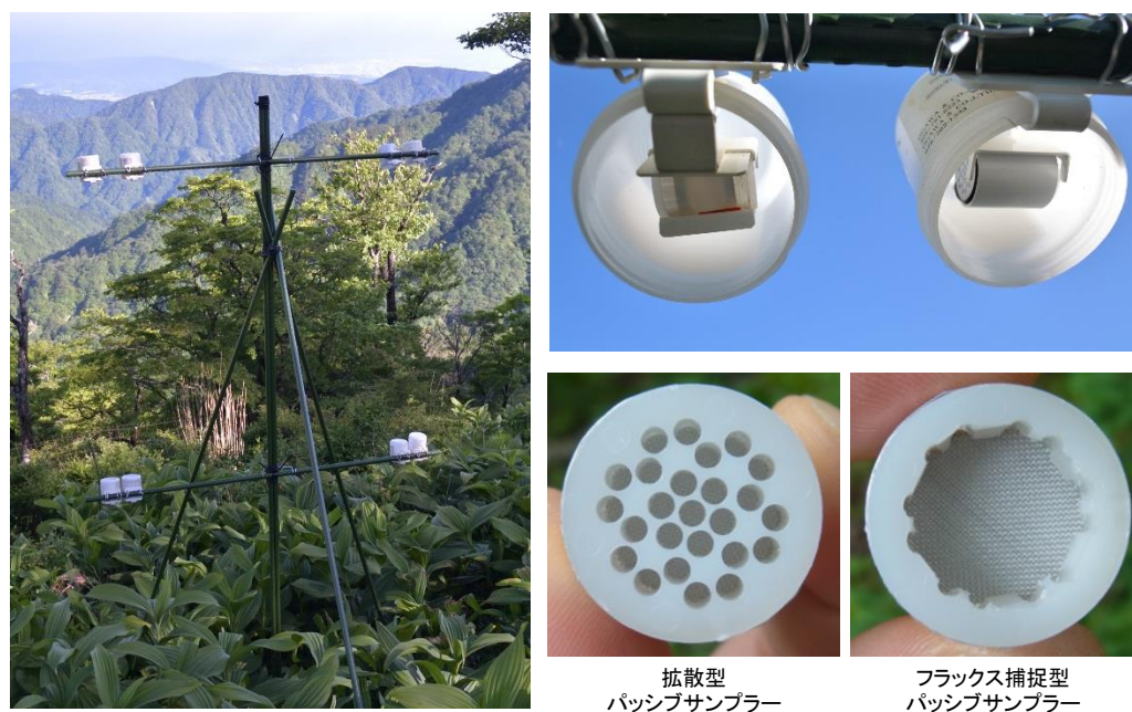
図2 オゾンパッシブサンプラーの設置状況
