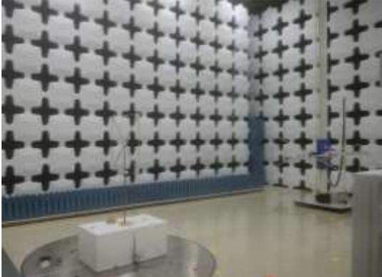
図-2 電波暗室でのループアンテナの特性試験
