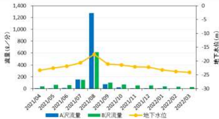
図-9 ヌタノ沢の河川流量と地下水位
