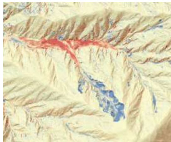
図-2 標高差分図 (山北町ゴウラノ沢付近、約 900m×700m) ※陰影起伏図を透過表示
