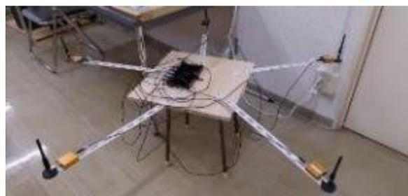
図-1 KrakenSDRを用いた追跡装置
