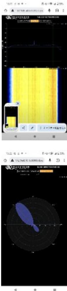
図2 KrakenSDRによる信号受信(上)と方探の様子(下)
