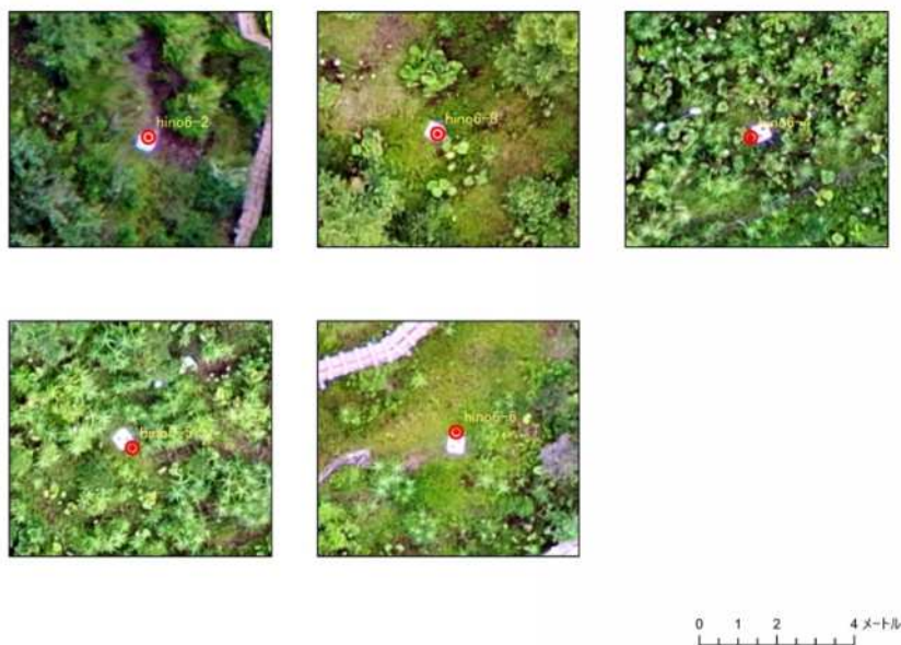
図1 檜洞丸-7撮影写真から作成した標定点5か所の位置精度 ◎がGNSSで測位した標定点の位置。白色の□が標定点標識
