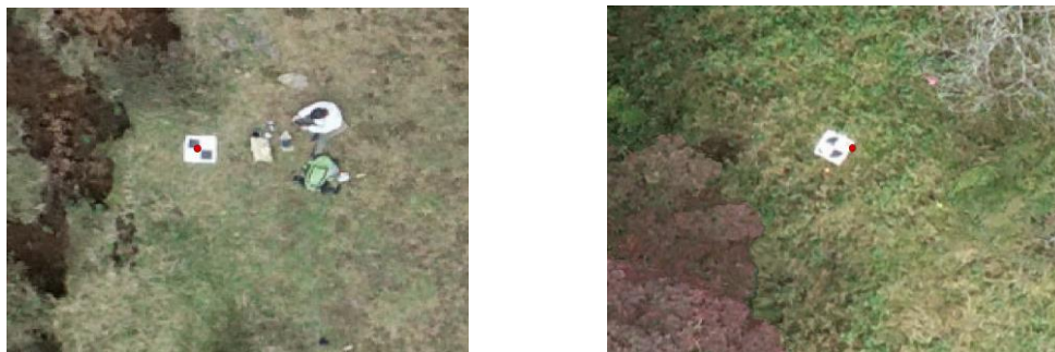
図-3 斜め撮影写真と GCP を用いて作成したオルソ画像と GNSS 測位した対空標識との位置精度の比較 (左: 約 0.05m 右: 約 0.20m)
