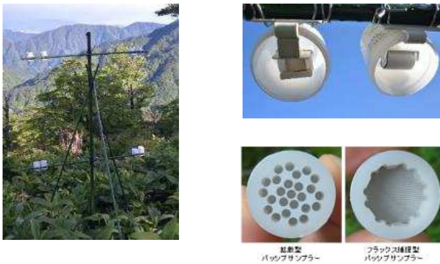
図-2 オゾンパッシブサンプラーの設置状況
